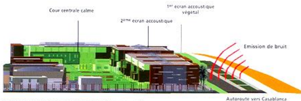
Schéma du principe de protection acoustique
