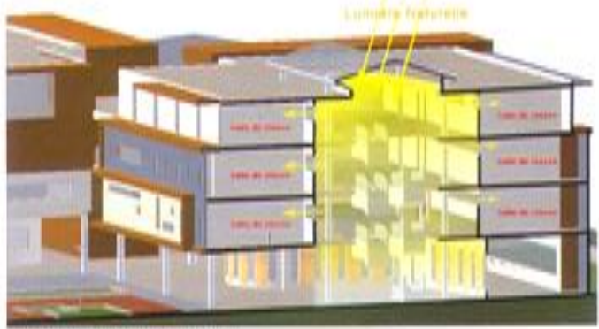
Principe d'éclairage naturel Coupe schématique sur le bâtiment Faculté d'ingénierie.
